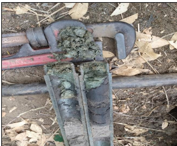
FOTO 02 – SPT 1 - EIXO 2a (4,50m)
