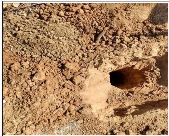
FURO 22 –. ST-22 - Silte arenoso pouco argiloso (0,80m)
