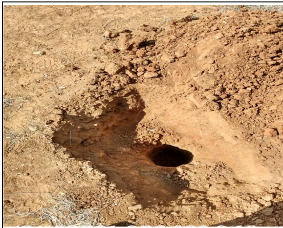
FURO 21 –. ST-21 - Silte pouco argiloso (0,60m)
