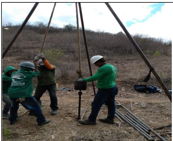
FOTO 01 –. SPT 1 - EIXO 2b (1,48m)
