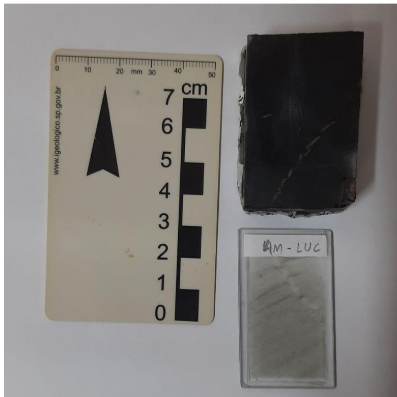
Figura 01 – Amostra da rocha estudada e, respectiva, lâmina petrográfica confeccionada.
