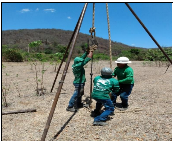
FOTO 01 –. SPT 1 - EIXO 3b (1,65m)
