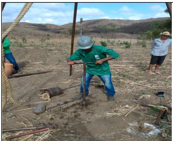
FOTO 01 –. SPT 1 - EIXO 3a (9,43m)
