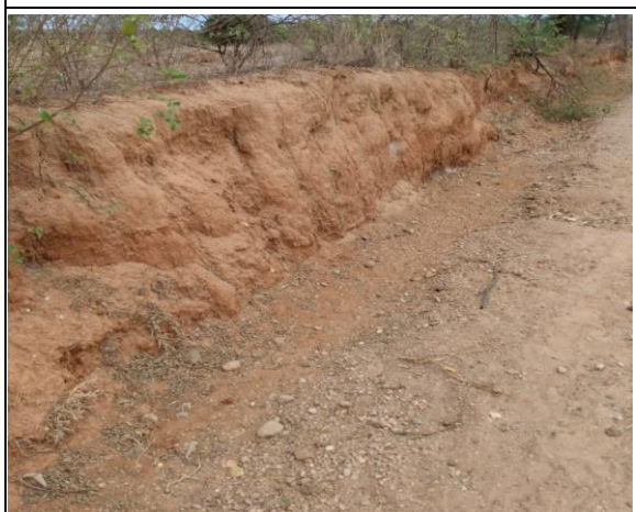
FOTO 03 –. ST-3 - Silte argiloso com seixos (1,00m)
