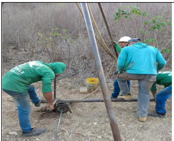
FOTO 07 –. SPT 4 - EIXO 2a (2,30m)
