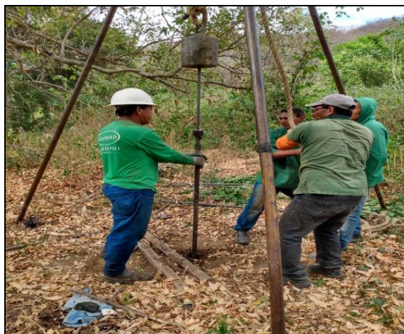
FOTO 02 –. SPT 2 - EIXO 2b (3,45m)
