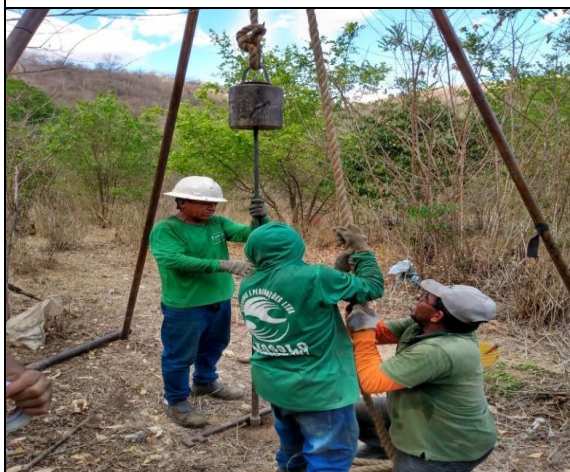
FOTO 06 – SPT 4 - EIXO 2a (2,30m)
