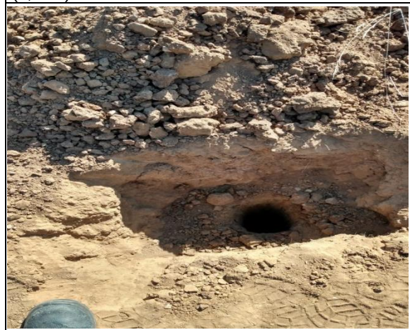
FURO 24 –. ST-24 - Silte arenoso (0,60m)
