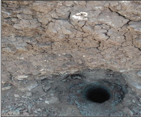
FURO 27 –. ST-27 - Silte com filito (0,70)
