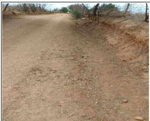
FOTO 01 –. ST-1 - Silte argiloso com filito (0,70m)
