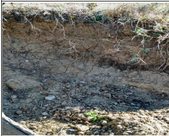
FURO 23 –. ST-23 - Silte argiloso com seixos (1,80m)
