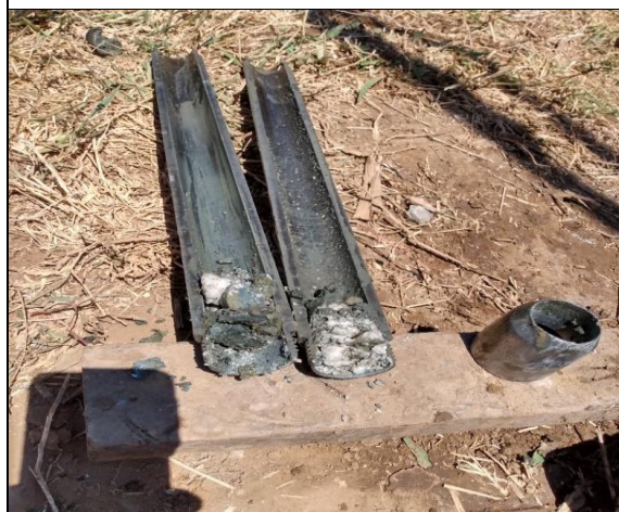
FOTO 04 –. SPT 2 - EIXO 3b (8,20m)
