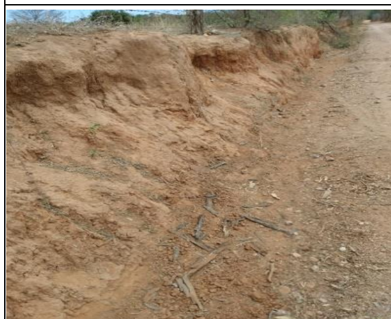
FOTO 04 –. ST-4-1 - Silte argiloso com filito (2,00m)
