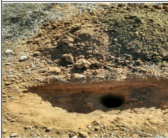
FURO 23 –. ST-23 - Silte argiloso com seixos (1,80m)
