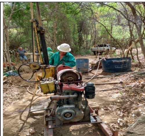
FOTO 07 – SR4 – Execução do Furo da Sondagem
